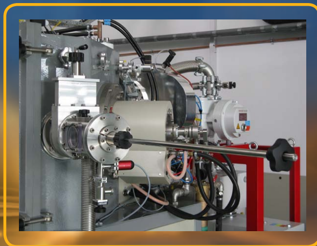
Widok komory roboczej z zainstalowanym źródłem łukowym i modułem „load-lock”
