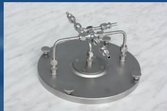
Komora według normy PN-EN ISO 16000-10
