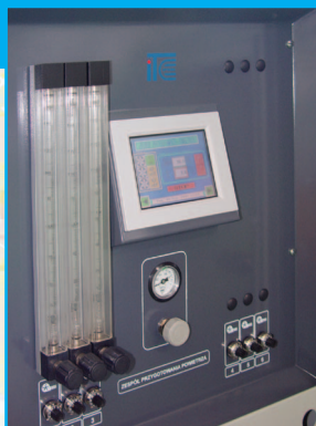
Pulpit operatora zespołu przygotowania powietrza dla trzech komór badawczych (3 rotametry)
