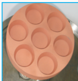
Multytygiel obrotowy, układ odchylenia wiązki elektronowej oraz planetarny układ obrotu podłoży hybrydowego urządzenia EB-PVD
