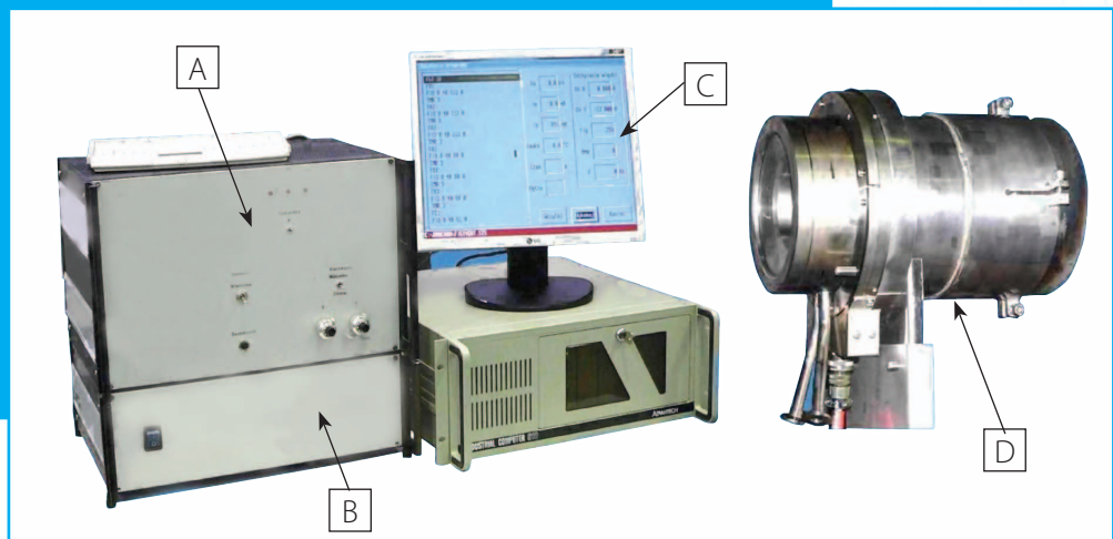
A – panel odchylenia statycznego, B – panel pomocniczy, C – komputer, D – układ odchylenia statycznego i dynamicznego, E – specjalistyczne oprogramowanie
