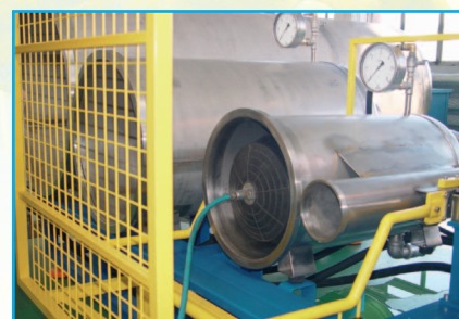
Badanie poduszki uszczelniającej o średnicy 400 mm
