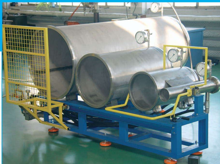
Układ zadawania ciśnienia wody wypychającej badaną poduszkę
