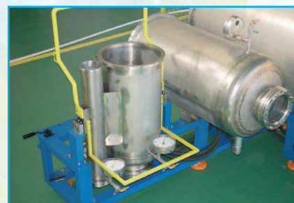
Wychylna sekcja urządzenia do badania poduszek napełnianych wodą
