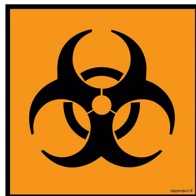
Substancja zagrożająca biologicznie
